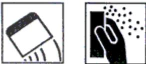
**PAVIMENTI E PIASTRELLE:** Per una perfetta tenuta d su piastelle opache, semilucide o lucide irruvidire il supporto abrasivando con carta specifica o smerigliatrice. Successivamente per eliminare ogni dislivello dovuto alle fughe si deve inserire una rete fibrata al momento dell'applicazione dello STUCCO P3D FLOOR e carteggiare .
